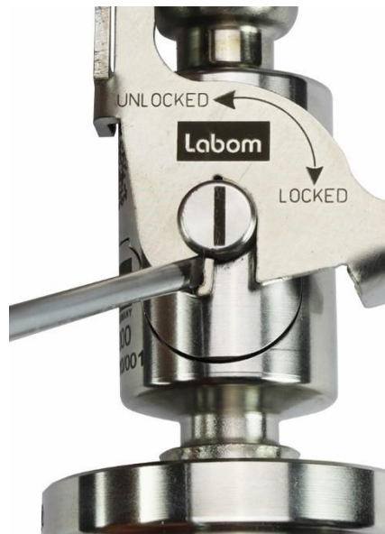
Abbildung 6: Sichern gegen Verlust des Bügels
