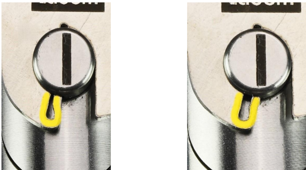
Abbildung 7: Ansicht vor und nach Verbiegen der Federlasche (entscheidender Bereich gelb hervorgehoben)
